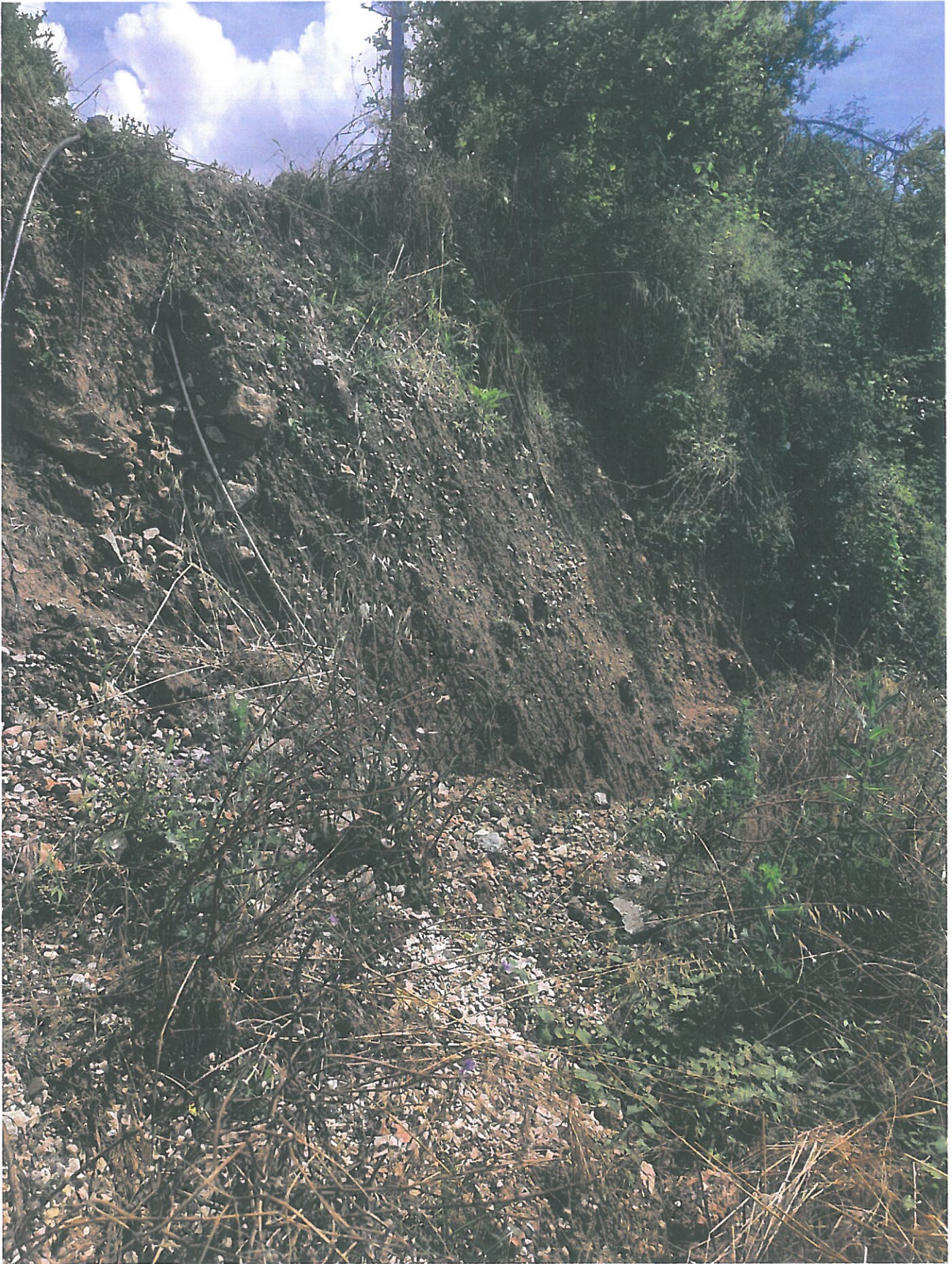
Foto 7 – Immagine realizzata durante il rilevamento geologico/ geomorfologico di dettaglio che mette in risalto il fianco sinistro della frana nella zona di Testa e della scarpata secondaria ( messa a giorno fronte detritico ad elevata componente piroclastica)
