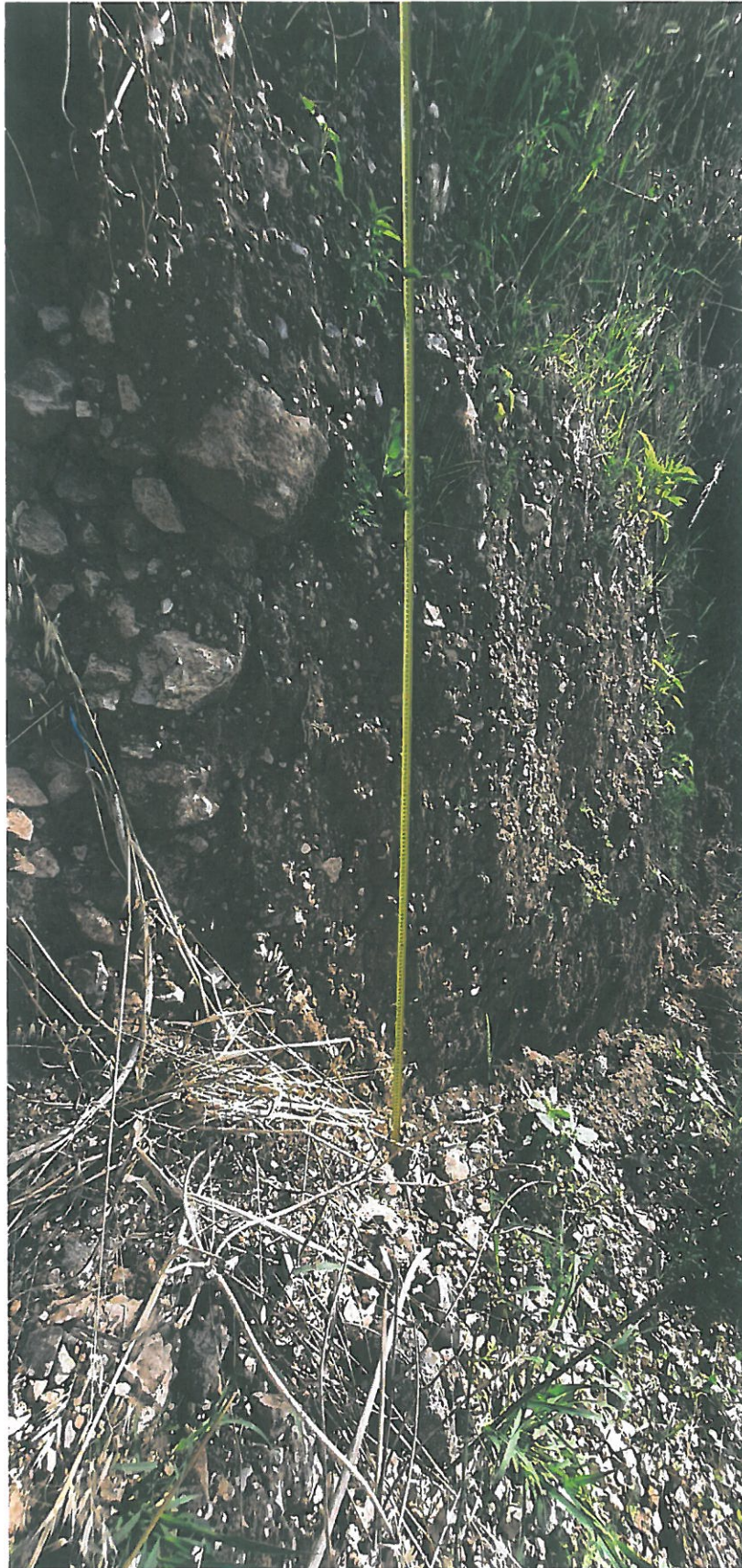
Foto 9 – Immagine di dettaglio realizzata durante il rilevamento geologico/ geomorfologico di dettaglio che mette in risalto il fianco sinistro della frana nella zona di Testa e della scarpata secondaria ( messa a giorno fronte detritico ad elevata componente piroclastica)
