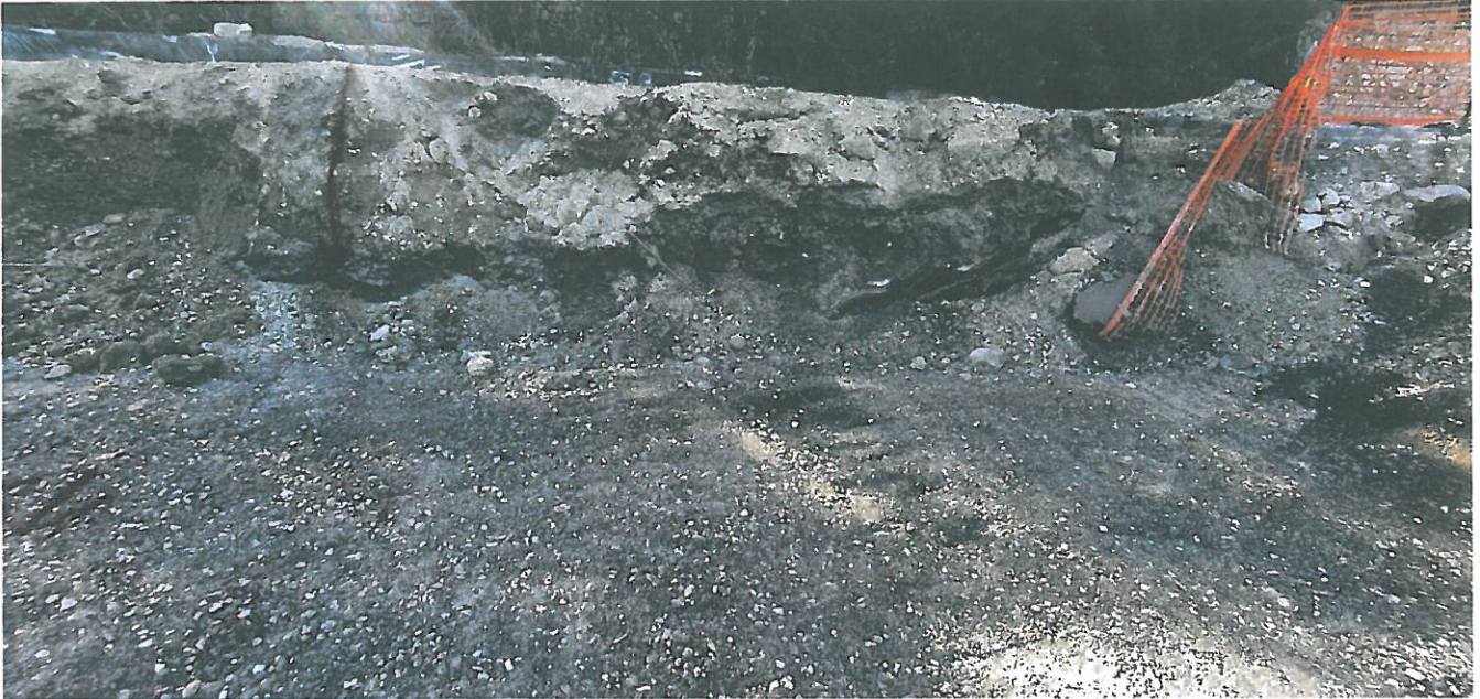
Foto 5 - Immagine realizzata durante il rilevamento geologico/ geomorfologico di dettaglio che mette in risalto la scarpata principale, il coronamento ed il fianco sinistro della frana (da notare che è stato modificato per realizzare la rampa per poter realizzare il sondaggio geognostico S4, carreggiata relitta direzione Cautano )
