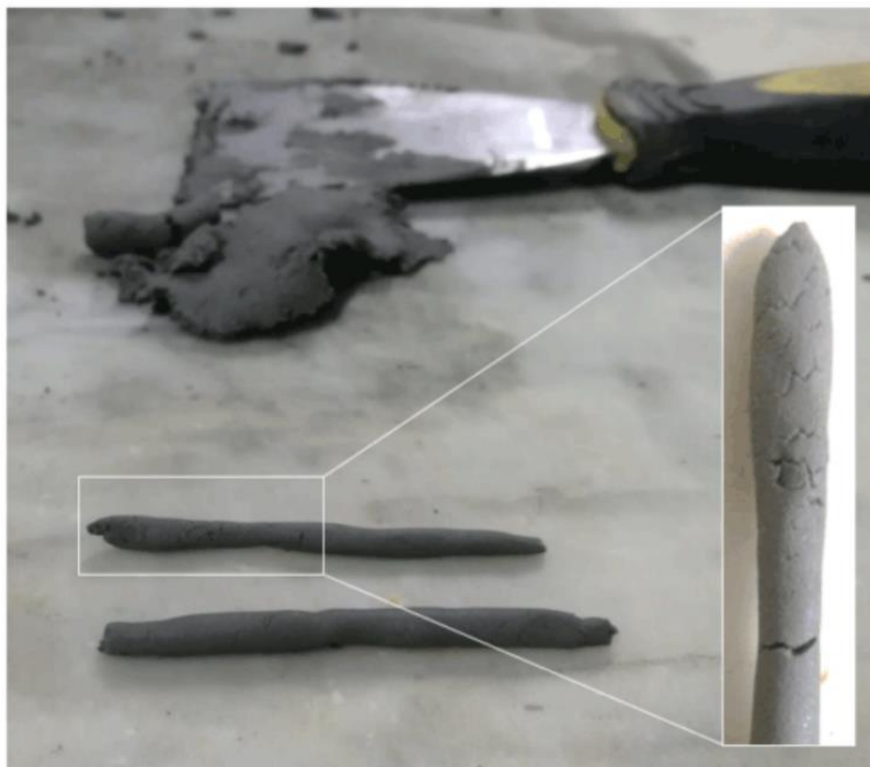
Figura 12 Esecuzione del limite di plasticità
