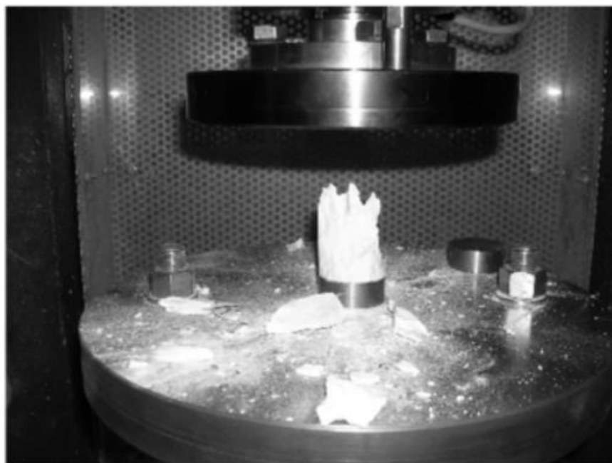
Figura 16 Esempio di apparecchiatura per Prova a compressione monoassiale
