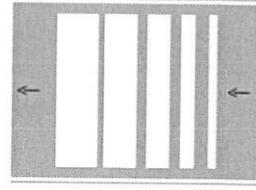
Sulla base delle indicazioni progettuali ovvero della Direzione Lavori, i sistemi di rallentamento ad **effetto acustico** saranno realizzati mediante irruvidimento della pavimentazione stradale ottenuta con la scarificazione o incisione superficiale della stessa o con l'applicazione di strati sottili di materiale in rilievo in aderenza, eventualmente integrato con dispositivi rifrangenti. Tali dispositivi possono anche determinare effetti vibratorii di limitata intensità.
